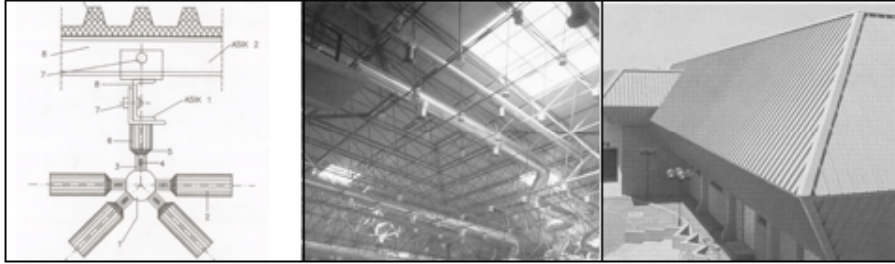
Şekil 6-Uzay kafes sistemlerinde alüminyum levha uygulama detayı ve örnekleri[4,6].
